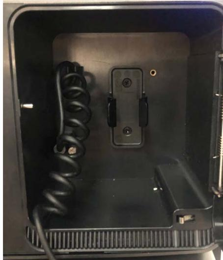
**Step 2** Conecte el cable de datos a la cámara corporal hasta que la estación muestre el cuadro de diálogo de conexión exitosa.
