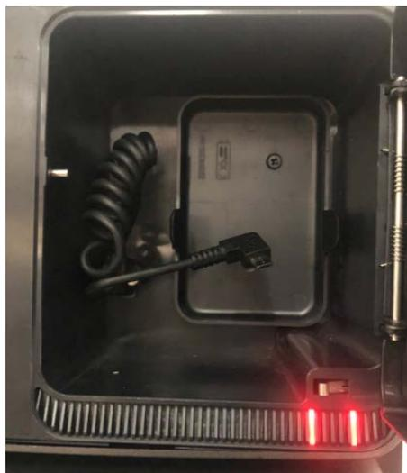
Figure 2-2 Saque el cable de datos (ranura MPT210)
