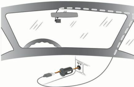
El cable corto está diseñado para ir hacia abajo hasta la fuente de alimentación del vehículo.
