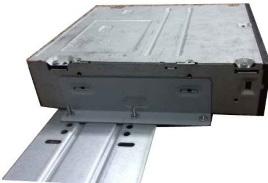
Figura 3-38 Instale la grabadora SATA
