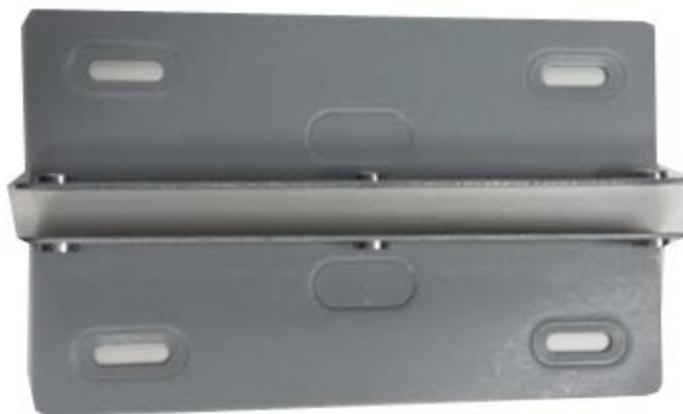
Figura 3-34 Extraiga el soporte del CD-ROM
