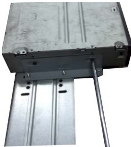
Figura 3-39 Apriete los tornillos
