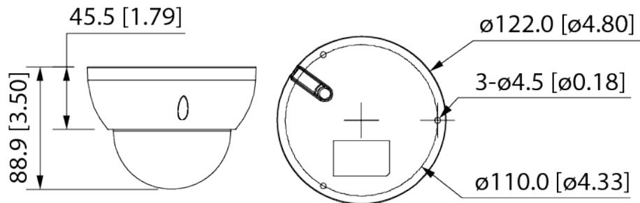
Figura 3-3 Dimensiones: Modelo B (mm [pulgadas])
