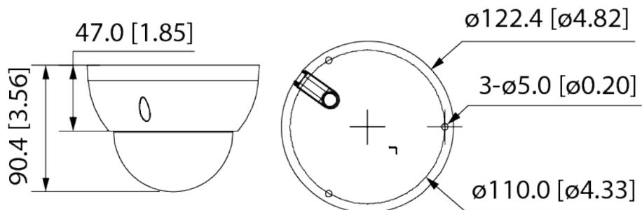
Figura 3-4 Dimensiones: Modelo C (mm [pulgadas])
