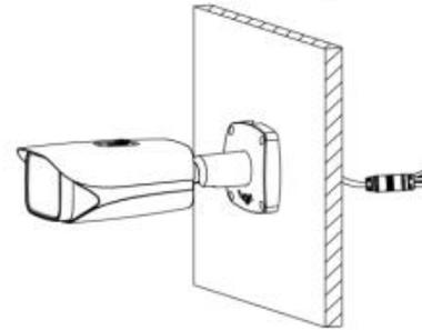
Cable que atraviesa la superficie de montaje
