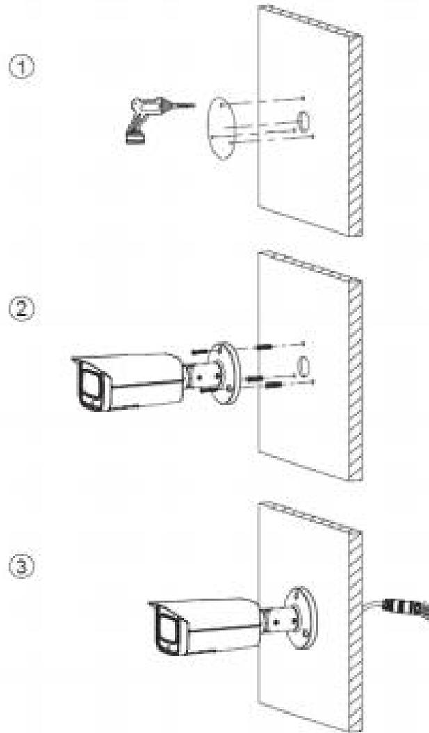
Cable que atraviesa la superficie de montaje
