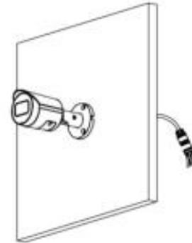
Cable que atraviesa la superficie de montaje
