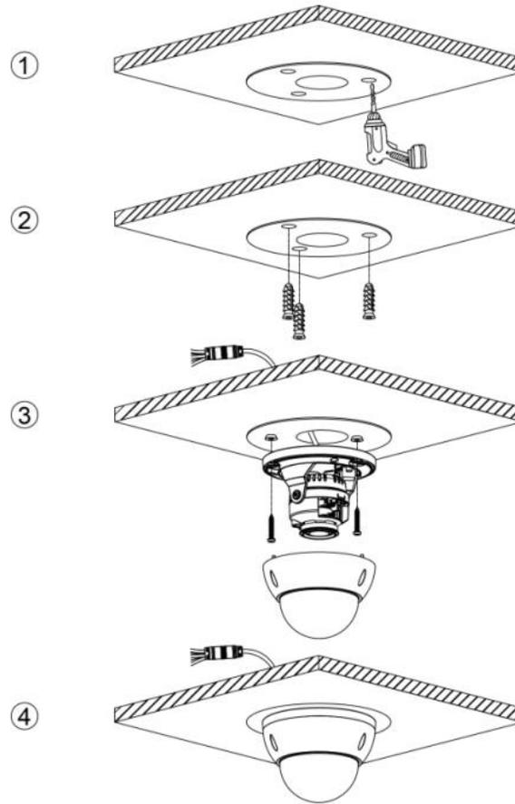
Cable que atraviesa la superficie de montaje
