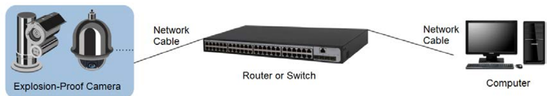
Figura 1-2 Conexión a través de un conmutador o enrutador
