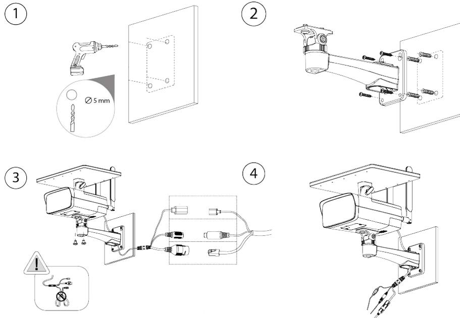
Figura 4-7 Cable que atraviesa la superficie de montaje
