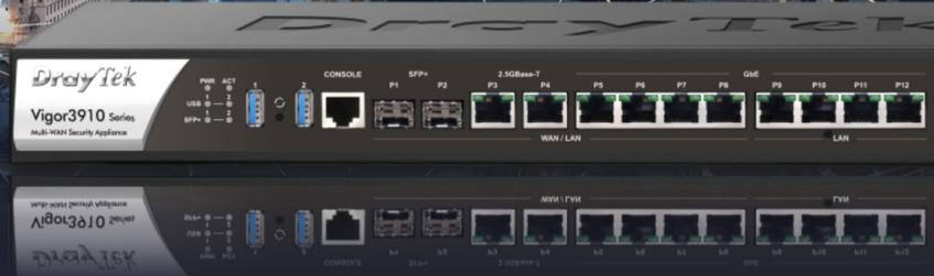
Vigor3910 es apto para redes que demandan ancho de banda. El enrutador cuenta con un potente procesador de cuatro núcleos, ocho interfaces conmutables WAN / LAN, incluidas dos 10G SFP + para conectividad de fibra, dos 2.5G Ethernet, RJ-45 y cuatro Gigabit Ethernet, RJ-45, que le brinda un rendimiento de NAT de hasta 9.4 Gbps. Además, el enrutador tiene cuatro Gigabit Ethernet, RJ-45 como interfaz LAN fija.
