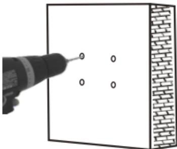
2) Fije el dispositivo con cuatro tornillos
