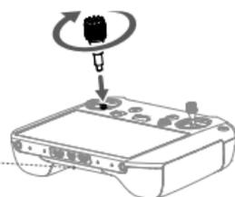
Acople las palancas de control y gírelas para fijarlas
