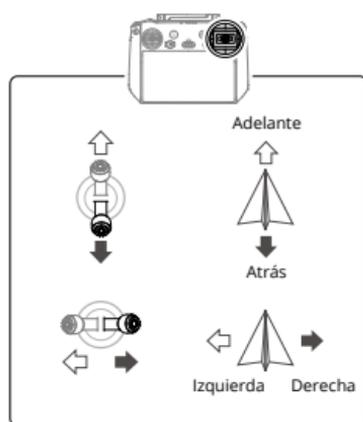
El modo predeterminado de las palancas de control es el modo 2. La palanca de control izquierda controla la altitud y la orientación de la aeronave, mientras que la palanca de control derecha controla los movimientos adelante, atrás y laterales.
