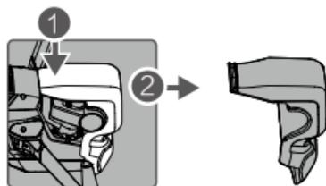
Retire el protector del estabilizador de la cámara
