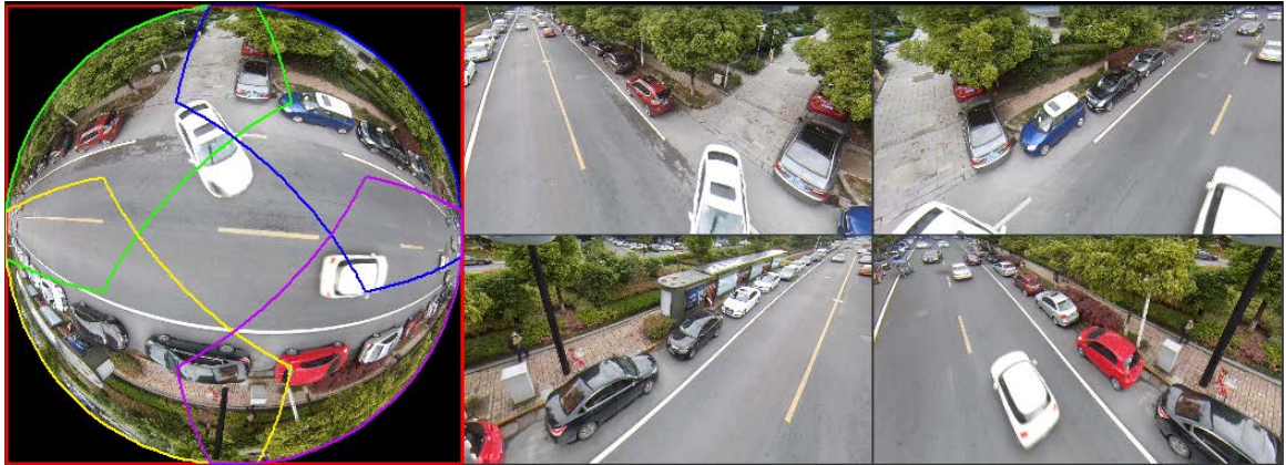
Figura 5-47 Corrección de la deformación
