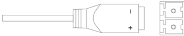
Figura 2-3 Puerto de entrada de alimentación de 24 VCA
