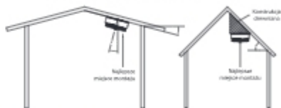
Figura 4-3 Posizione di installazione (2)
