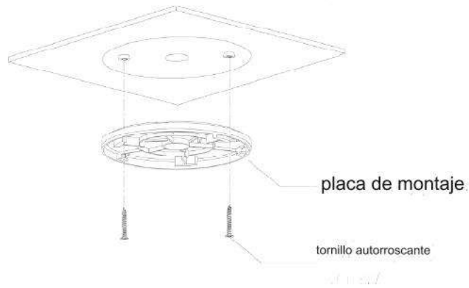
Figura 4-4 Paso de instalación (1)
