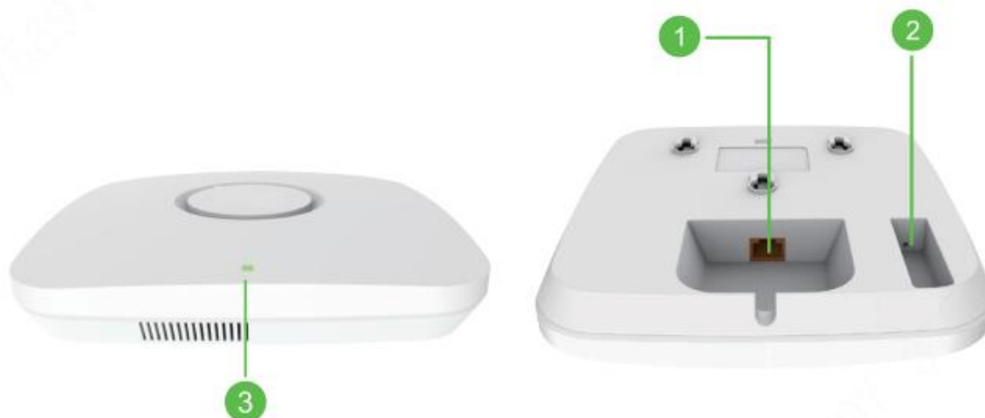
Figure 2-2 Descripciones de los puertos de la estación AP
