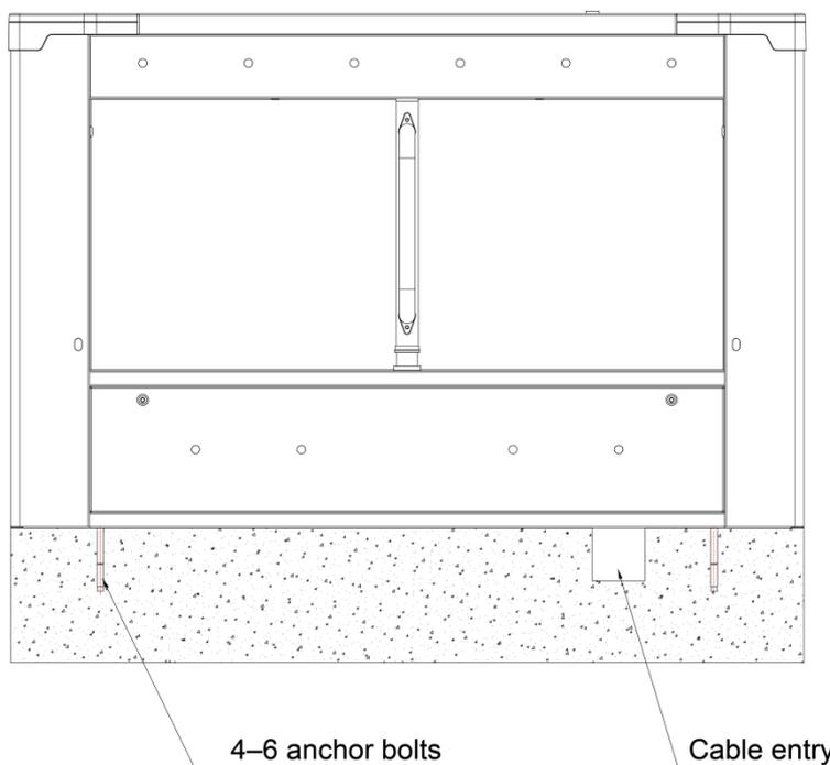
**Paso 3** Levante el torniquete, ajuste su posición, haga que los orificios del torniquete se superpongan con el perno de anclaje y luego coloque el torniquete en el suelo.
