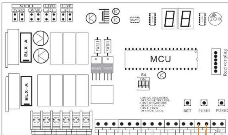
Para activar la salida de ELOCK colocar el dipswitch 3 en ON.
