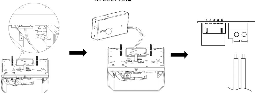
**Precaución:** Después de realizar la conexiones , realice una activacion del motor si la cerradura se retrae esta conectada de manera correcta , si la cerradura no se retrae hay que cambiar la polaridad de los cables.
