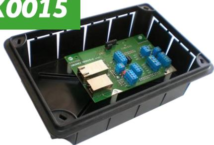
El Terminal de empotrar NX0015 viene ya instalado dentro del cabecero y precableado con el resto de dispositivos de la solución paciente enfermera. Se puede integrar con cualquiera de los elementos adicionales del sistema de llamada paciente-enfermera que no vienen integrados en el cabecero (pulsadores adicionales, lectores de tarjetas, luces de pasillo, etc.)
