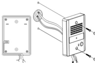
5. Coloque el sistema en la pared y móntelo con los tornillos suministrados.
