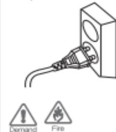
Sujete el enchufe firmemente al desenchufar el cable de alimentación (una parte del cable de cobre puede desconectarse si solo se agarra el cable al tirar del cable).
