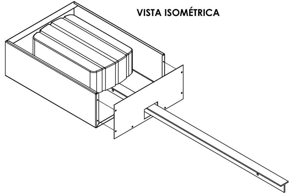
1. Fabricado en lámina en acero galvanizado calibre 20.
