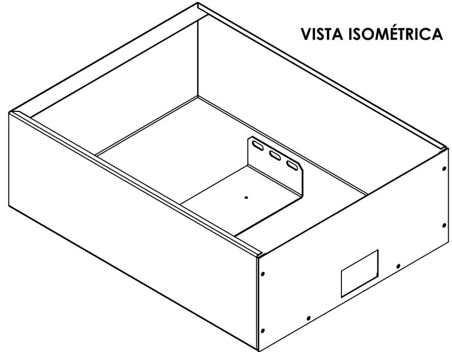
1. Fabricado en lámina en acero galvanizado calibre 20.
