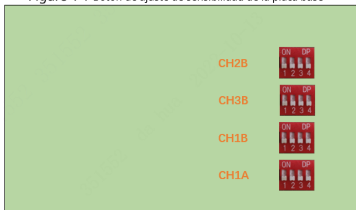
Figure 4-1 Botón de ajuste de sensibilidad de la placa base
