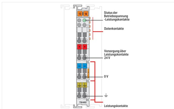
Este módulo de alimentación dota a los acopladores de comunicaciones y algunos módulos de E/S que lo requieren del correspondiente potencial de alimentación.
