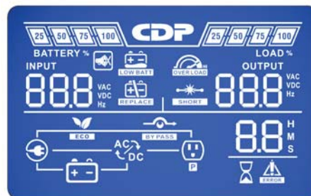
Muestra voltajes de entrada, salida, tiempos de autonomía y carga de batería
