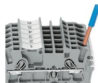
**Inserción de un conductor a través de la conexión enchufable:**
