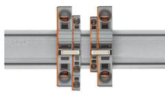
**Reducción mediante peine de puentes:** El punteado en el lado abierto de la borna con placa final permite puntear con dos tamaños de sección con conductores de 16 mm<sup>2</sup> y 10 mm<sup>2</sup> y con solo tamaño de sección con conductores de 6/4/2,5 mm<sup>2</sup>. Un ejemplo: de 16 mm<sup>2</sup> a 6 mm<sup>2</sup> (ver ilustración arriba) o de 10 mm<sup>2</sup> a 4 mm<sup>2</sup>.
