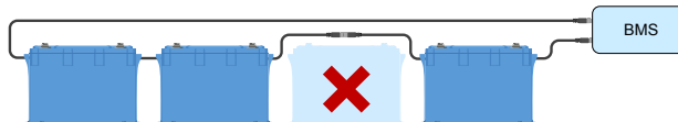
Eliminación de un error BMS haciendo un bypass de una batería sospechosa
