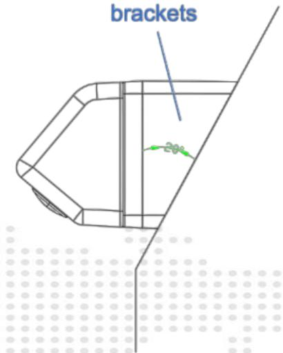
El bracket de Meriva Streamax es un soporte diseñado para sostener y montar una cámara móvil modelo MCA51. Este accesorio proporciona un montaje estable y seguro para la cámara, permitiendo su instalación en diferentes ubicaciones del vehículo.
