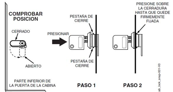
Figura 1. Instalación de la Cerradura de la Cabina
