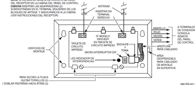
Figura 9. Receptor Vía Radio 5881EN (sin tapa)
