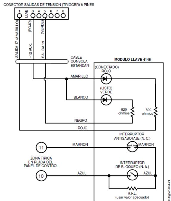
**Figura 10. Cableado Módulo de Conexión/ Desconexión por Llave**
