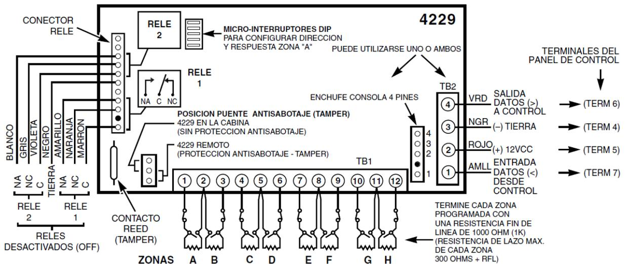
**Figura 8. Conexiones, 4219 y 4229 (Mostrado 4229)**
