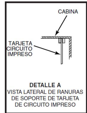
INSTALACION CON TARJETA DE CIRCUITO IMPRESO DE UN RECEPTOR
