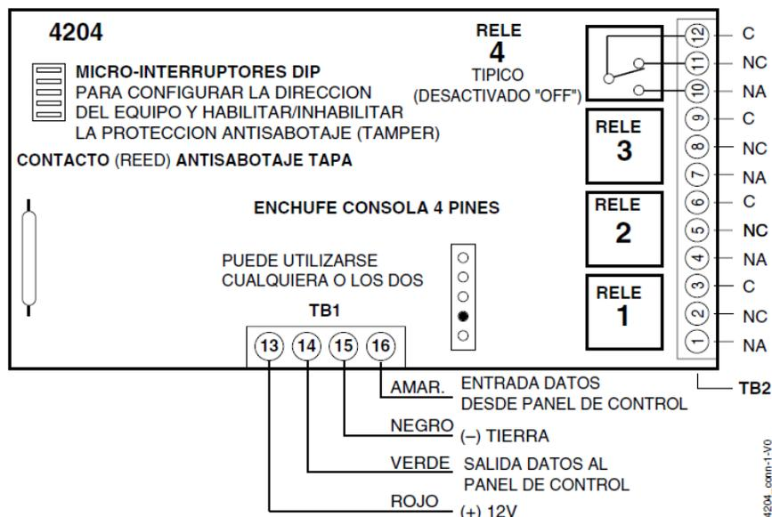
**Figura 11. Conexiones del Módulo 4204 al Panel de Control**
