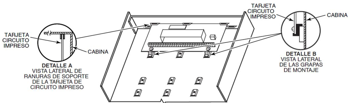
Figura 2. Montaje de la Tarjeta de Circuito Impreso
