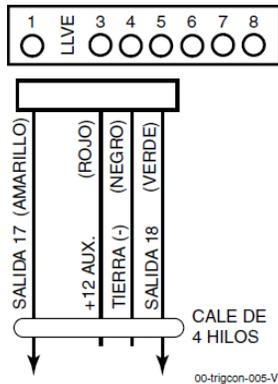
Figura 13. Conector Salidas de Voltaje en Placa con Cable de 4 Hilos para Uso Sólo de Salidas de Voltaje
