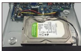
(3) Coloque el disco duro en la parte inferior del dispositivo.
