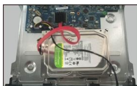
(4) Conecte los cables de alimentación y de datos.
