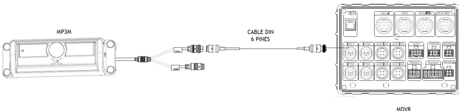
El MP3M maestro se conecta al cable de extensión del MDVR: Un conector macho de aviación de 6 PIN y un conector hembra de aviación de 6PIN
