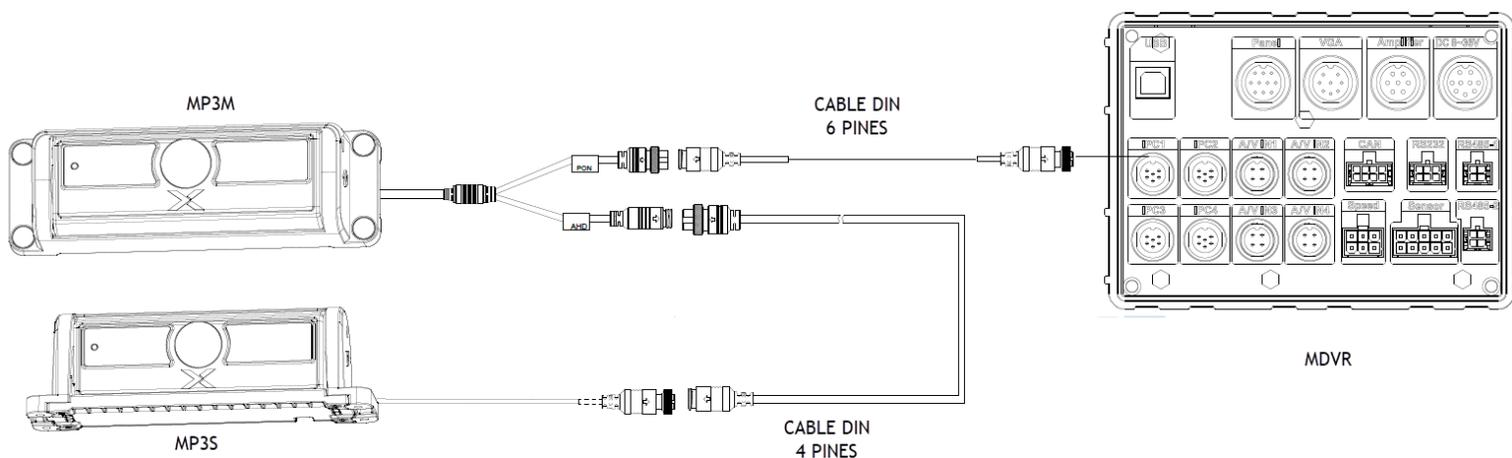
El MP3M maestro se conecta al cable de extensión del MDVR: Un cable con conector macho de aviación de 6PIN y un conector hembra de aviación de 6PIN.
