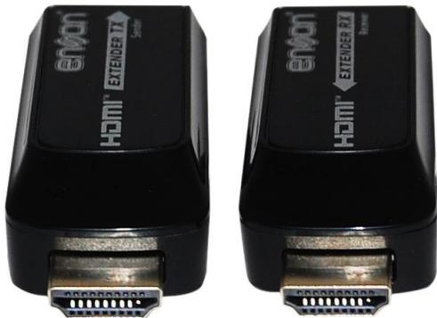
Este extensor HDMI incluye una unidad transmisora (TX) y una unidad receptora (RX), trabajando como un par. Permite la transmisión y la extensión sin comprimir la señal HDMI Full HD 1080p@60Hz a través del cable de red CAT6/6A/7, la distancia de transmisión es de hasta 50 metros
