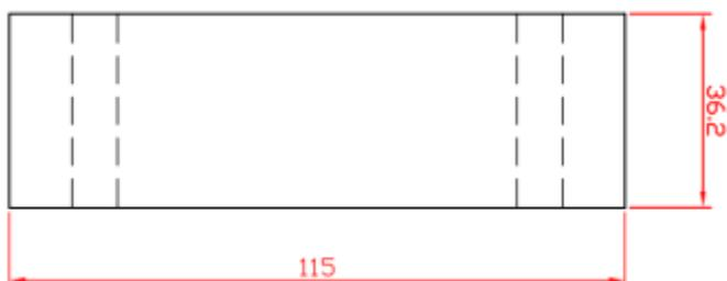
Caja universal ABS y tapa ciega color blanco, ideales para proteger conexiones de CCTV de una manera más estética, para ocultar uniones empalmes o punto de registro. Cuenta con insertos roscados de cobre para anclaje de placas. Montaje para superficies planas.
