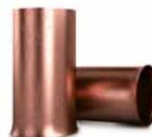
**AT-072NCXX:** Adaptadores de cobre de diámetro variable donde XX indica los mm<sup>2</sup> del cable final. Se utilizan para incrementar la sección de un conductor de forma que acopla en un molde diseñado para ese cable XX de mayor tamaño. XX = 50, 70, 120...
