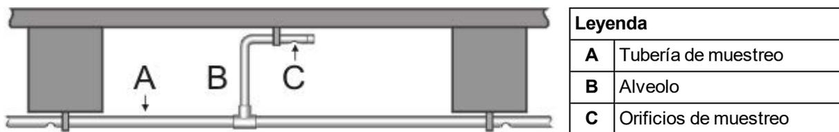
Figura 5-5: Muestreo entre vigas con ramales
