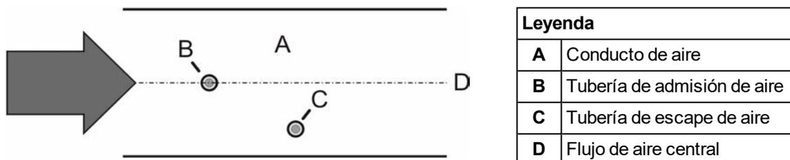
Figura 5-14: Ubicación de las tuberías en el conducto
