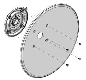
Utilice una llave hexagonal de 5 mm al montar la antena
