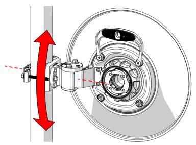
Utilice una llave de carraca de 13 mm para apretar los pernos de elevación
