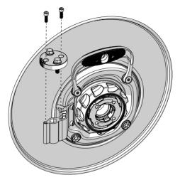
Utilice una llave hexagonal de 5 mm al montar la antena
