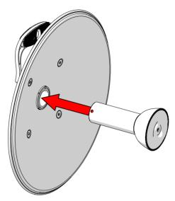
Siga girando el subreflector UltraDish ™ en cualquier dirección hasta que el pestillo de resorte esté enganchado.
