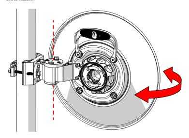
Utilice una llave de carraca de 13 mm para apretar los pernos de azimut
