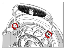
Utilice una llave hexagonal de 5 mm para desmontar la antena.
