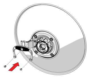
Utilice una llave hexagonal de 5 mm al montar la antena
