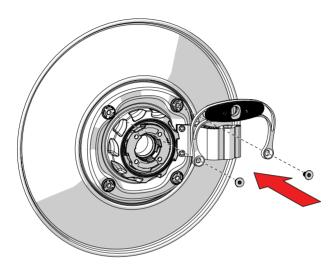
Utilice una llave hexagonal de 5 mm al montar la antena
