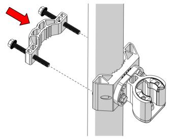
Utilice una llave de carraca de 13 mm para montar el soporte
