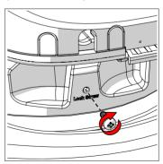
Apriete el tornillo de bloqueo para asegurarel mecanismo de bloqueo TwistPort ™.
