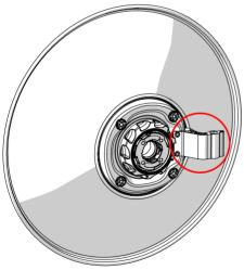
Configuración para el montajeen el lado **izquierdo** del poste
