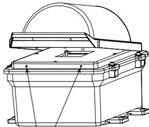
AVISO IMPORTANTE PARA ZONAS MOJADAS O DE LAVADO, STI RECOMIENDA PERFORAR (2) AGUJEROS DE DESAGOTE DE 1/8" (3mm) EN ESTA ÁREA PARA IMPEDIR LA ACUMULACIÓN DE AGUA DENTRO DEL CERRAMIENTO QUE PUEDE CAUSAR DAÑOS A LOS COMPONENTES ELECTRÓNICOS.
