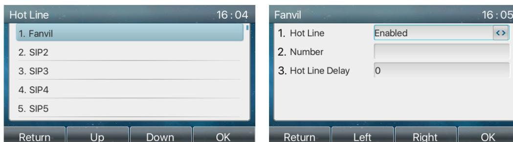
**Imagen 59 - Interfaz de configuración de línea directa telefónica**
