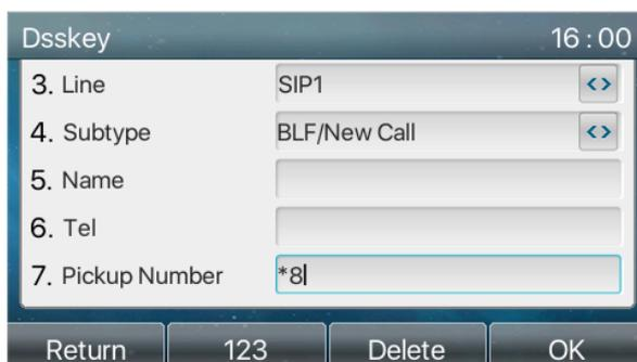
**Imagen 52 - Configuración de recogida de teléfono**
