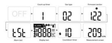
La unidad mostrará el tipo de gas, la versión de firmware, la pantalla / prueba de alarma, seguido de una estabilización de 10 segundos. Una vez que se completa la cuenta regresiva, el monitor pasa por defecto al modo de medición, mostrando las lecturas de gas y el icono.
