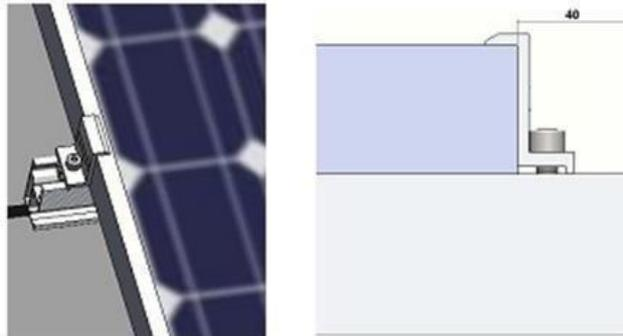
Coloque el sujetador intermedio como se muestra en la figura:
