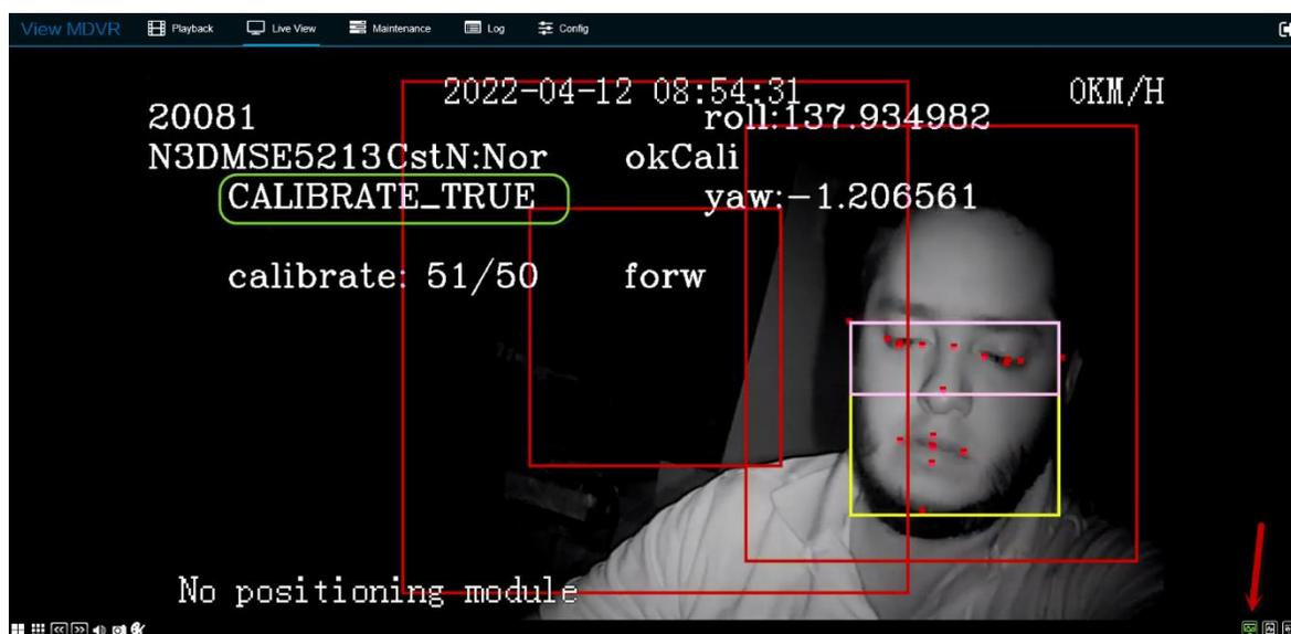
Al terminar con la calibración del sensor y el estado es **true**, regresamos al menú de **IA** para seleccionar las opciones que deseamos que identifique el sensor. Seleccionamos la opción de **DSM** y habilitamos las opciones.
