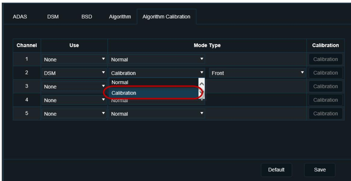
Después de habilitar la opción de calibration, es necesario seleccionar la posición del sensor. Esto depende a la instalación que se realice; el sensor puede ser instalado a un costado o frente al conductor.
