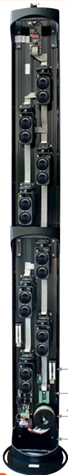
CALENTADORES TERMOSTAZIONATI TERMINALES CON SALIDA RS485 ENTRADA DE ALIMENTACION 230Vac ESPACIO BATERIA 7 AH
