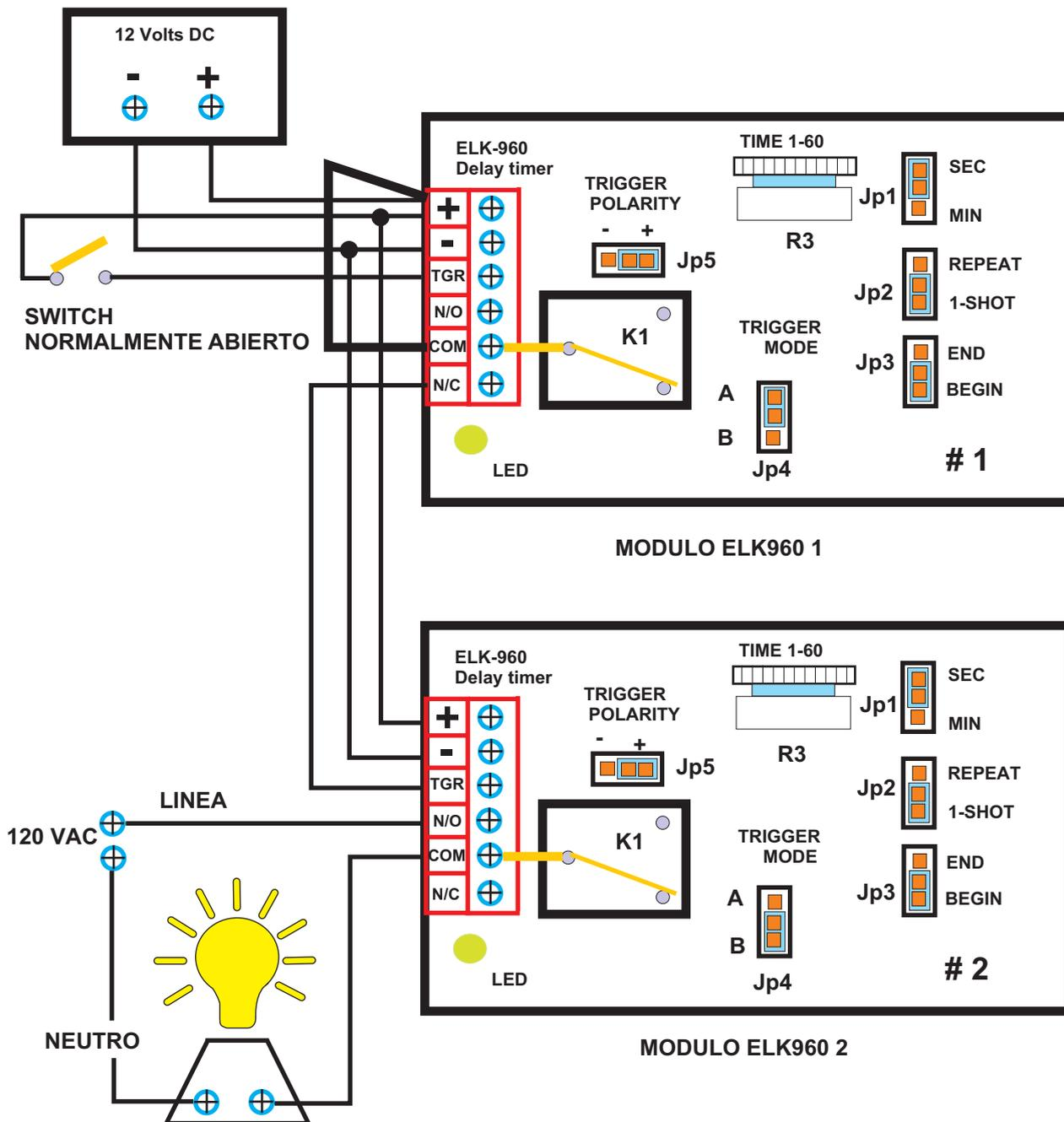
**NOTA :** La aplicación puede ser variada, por ejemplo en un banco, donde se utiliza un teclado, en el momento de ingresar el código se obtiene un pulso normalmente abierto, el cual va conectado a el primer modulo elk960, y despues de un tiempo ( el cual es programable ya sea en segundos ó en minutos ) activa a el segundo modulo elk960 para poder abrir la puerta, o encender una luz , etc. El tiempo que usted desee desde 1 segundo hasta 1 hora.
